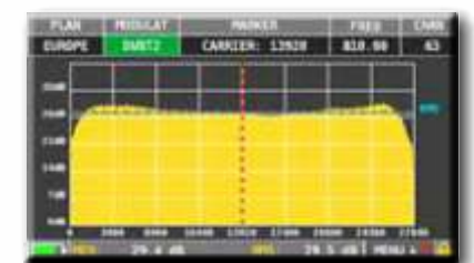
MER Versus CARRIER MER Messung der einzelnen Träger (optional)
