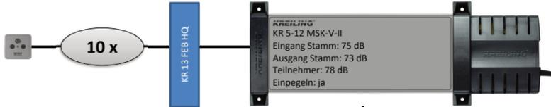
Maximale Länge vom Multischalter bis zur Dose 60m bei Verwendung einer SAT SD 3 uk (3-Loch Antennendose)
