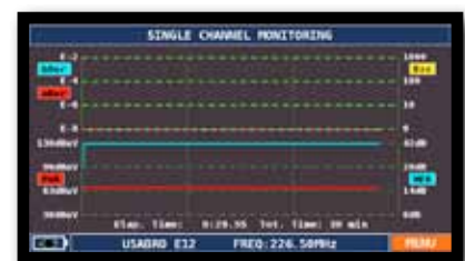
Langzeitüberwachung eines Kanals (z.B. über 30 Minuten)
