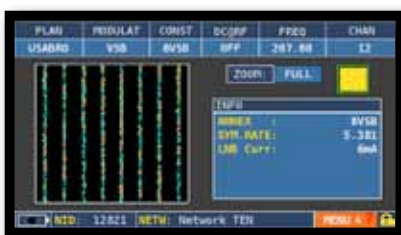
VSB Konstellation, rechts werden die entsprechenden Modulationsparameter gezeigt
