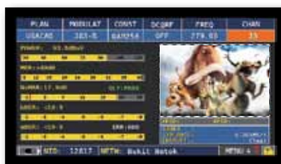
J83-B Signal: alle Messungen, Bilddarstellung und Parameter auf einem Bildschirm
