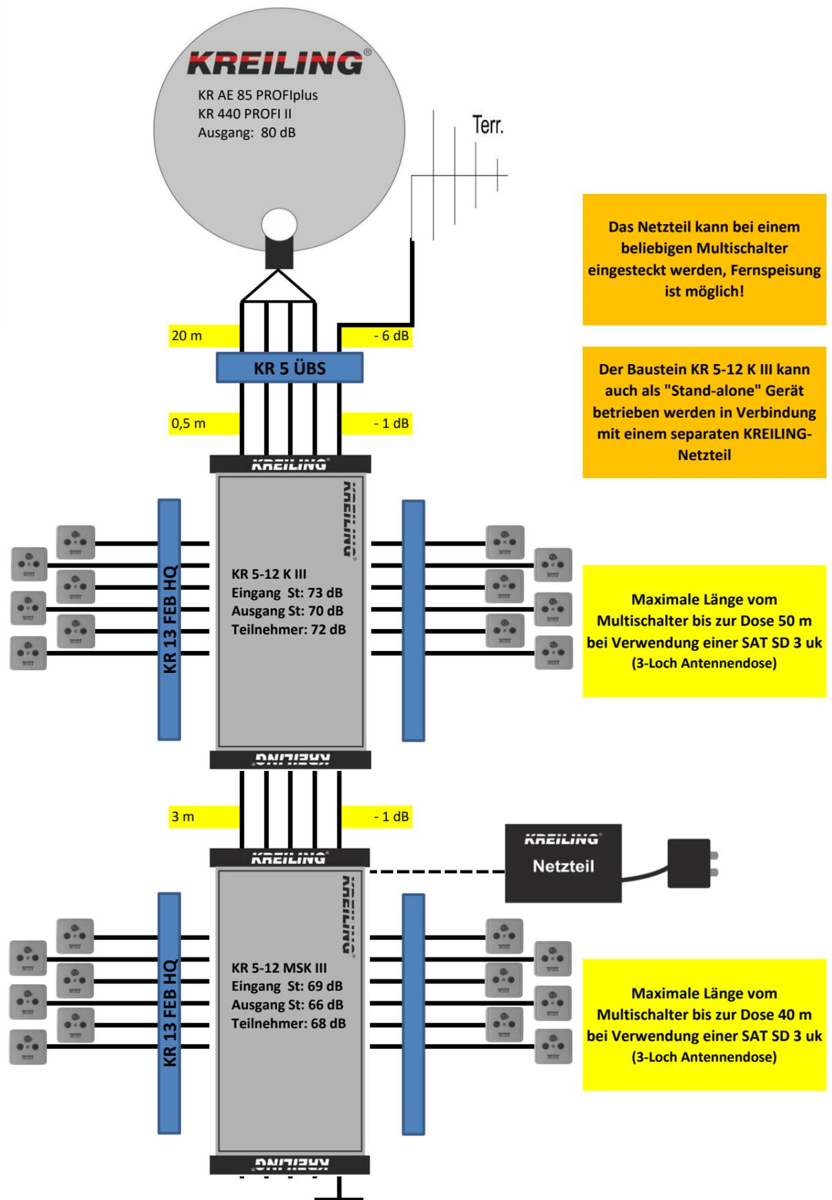
Das Netzteil kann bei einem beliebigen Multischalter eingesteckt werden, Fernspeisung ist möglich!
