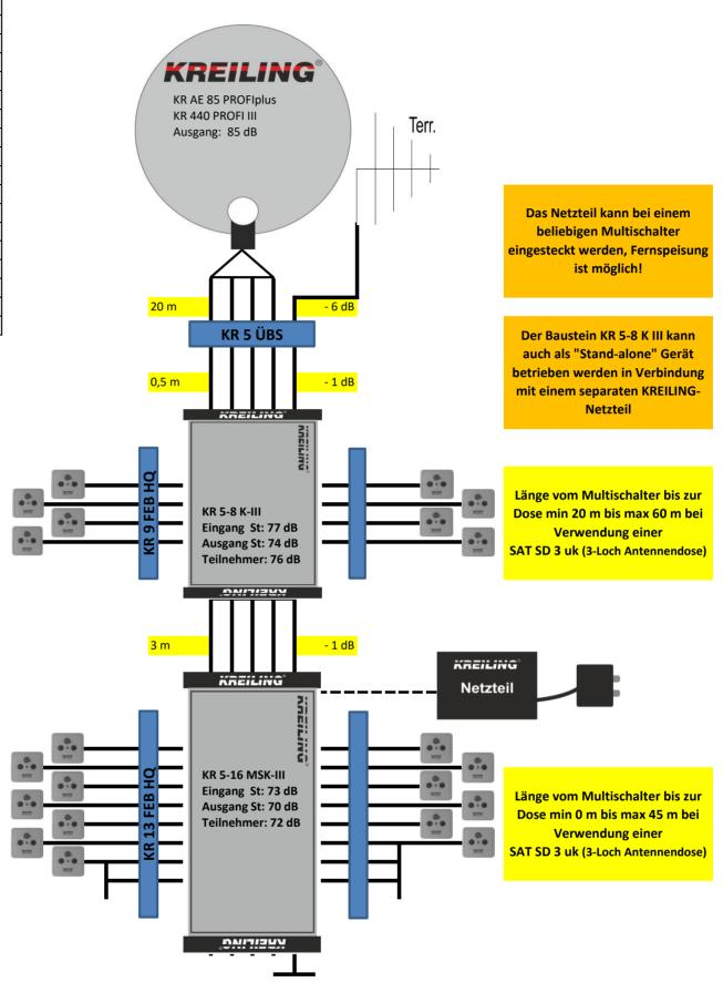
Bei kürzeren Kabelwegen als angegeben kann es bei manchen TV zu übersteuern (Pegel an der Dose über 71 dB) kommen (auch zeitweise). Dann sollten Dosen mit höherer Dämpfung (wie SAT MM 3D/10dB) zum Einsatz kommen!
