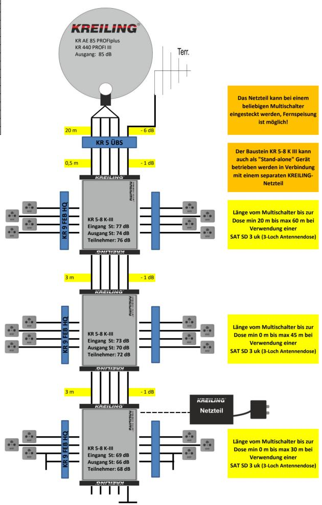
Bei kürzeren Kabelwegen als angegeben kann es bei manchen TV zu übersteuern (Pegel an der Dose über 71 dB) kommen (auch zeitweise). Dann sollten Dosen mit höherer Dämpfung (wie SAT MM 3D/10dB) zum Einsatz kommen!
