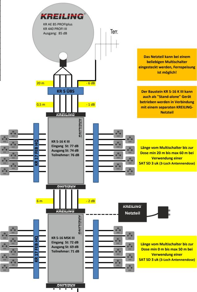
Bei kürzeren Kabelwegen als angegeben kann es bei manchen TV zu übersteuern (Pegel an der Dose über 71 dB) kommen (auch zeitweise). Dann sollten Dosen mit höherer Dämpfung (wie SAT MM 3D/10dB) zum Einsatz kommen!
